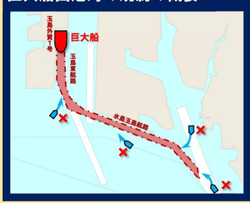
水島玉島航路及び玉島東航路を航行する船舶及び航路外より入航・横切りしようとする船舶は、行き会いまたは巨大船の直前の航行とならないよう「水島港運航調整ガイドライン」を確認の上、安全航行をお願いします。
